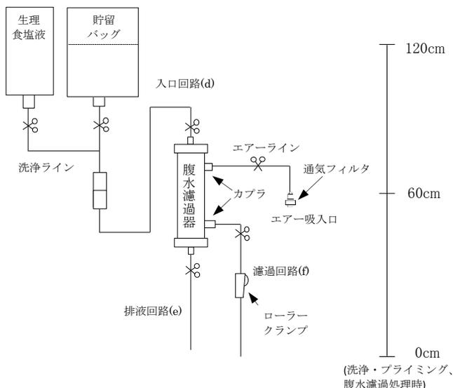
図7 内圧濾過法(落差式)の回路図
