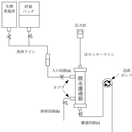
図6 陰圧ポンプ式外圧濾過法の回路図
