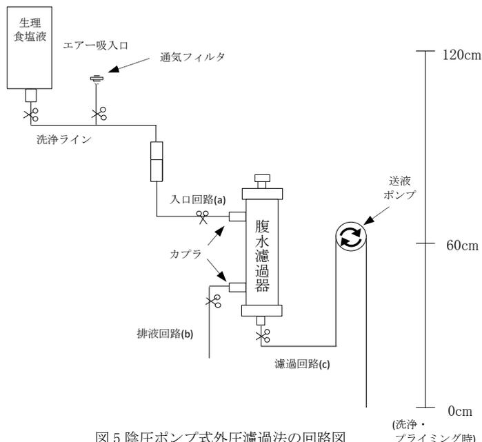
図5 陰圧ポンプ式外圧濾過法の回路図
