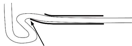
図2. 穿刺針刃先とカテーテル表面との接触及び損傷
