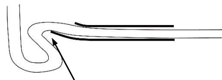
図2. 穿刺針刃先とカテーテル表面との接触及び損傷
